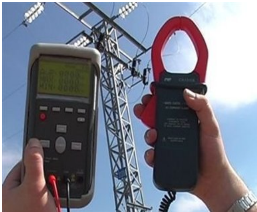
Medidor utilizado para medir los vatios en la potencia eléctrica
